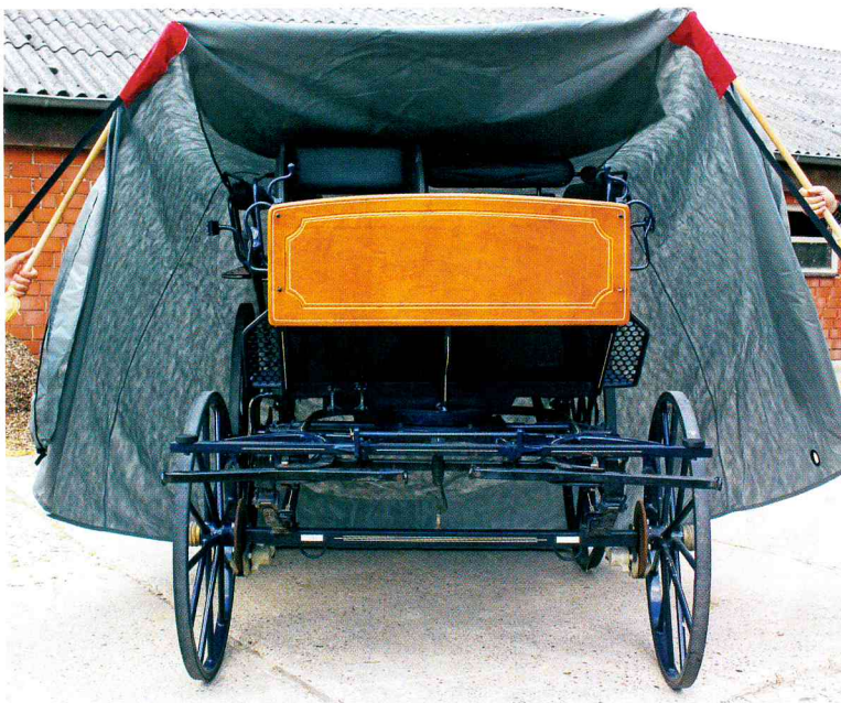
Die Schutzhaube lässt sich mit zwei Besen (linkes Bild) ganz einfach über größere Fahrzeuge stülpen. Zwei Gurtbänder mit Schlaufe unterstützen beim Ziehen. Außerdem kann mit ihnen die Haube am Fahrzeug fixiert werden (rechtes Bild). Fotos: Thomas Sagkob
